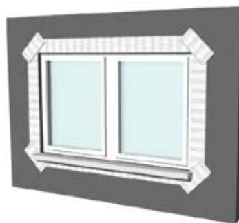
Obrázek č. 8: Vyztužení okrajů stavebních otvorů sklotextilní tkaninou
